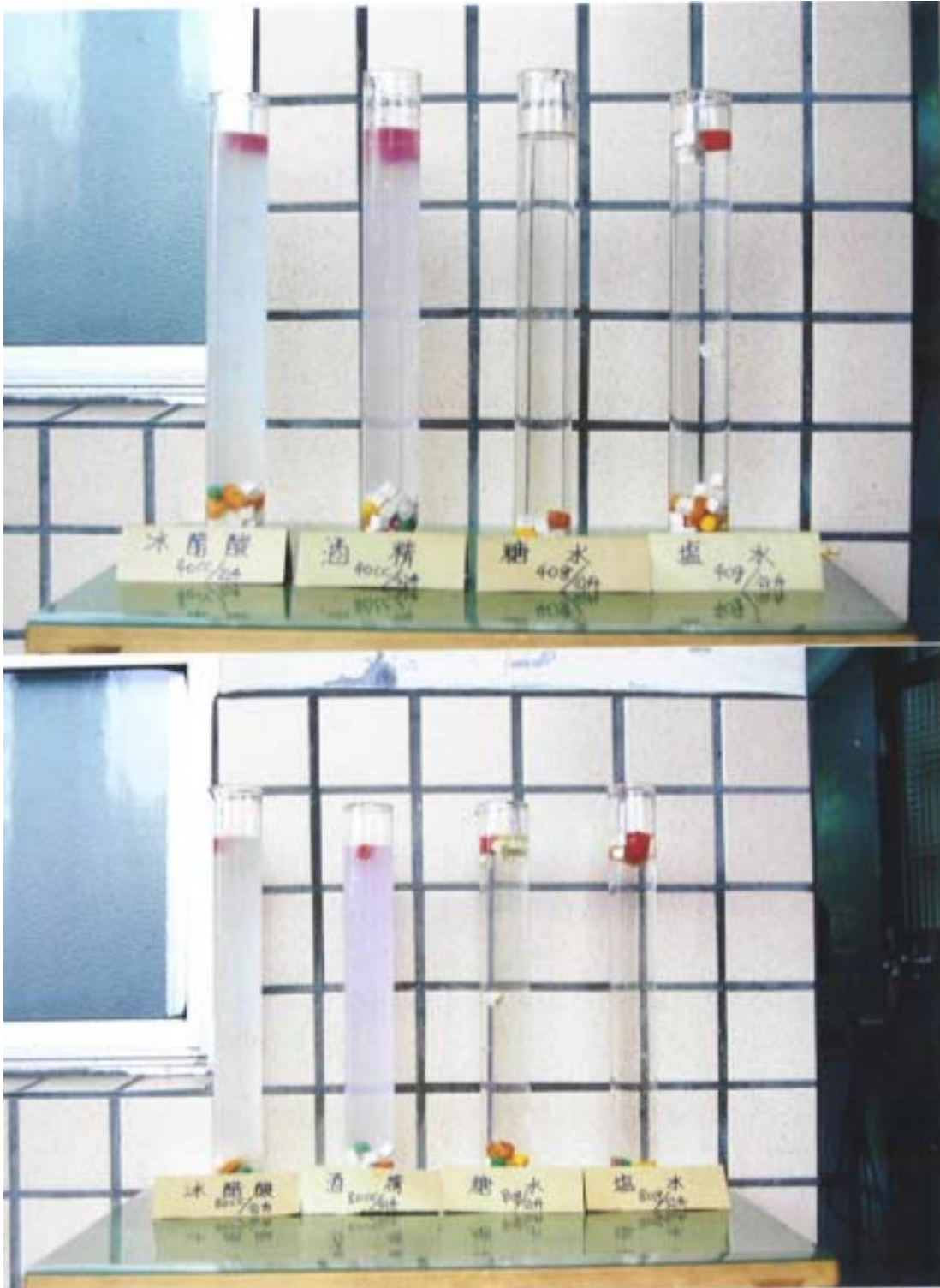
圖片說明：鹽水 40g/l、糖水 80g/l 時，塑膠塊開始有懸浮的情形，此時水溶液密度約為 1.028 左右 \text{g/cm}^3 。(塑膠塊密度約 1.03 \text{ g/cm}^3 )
