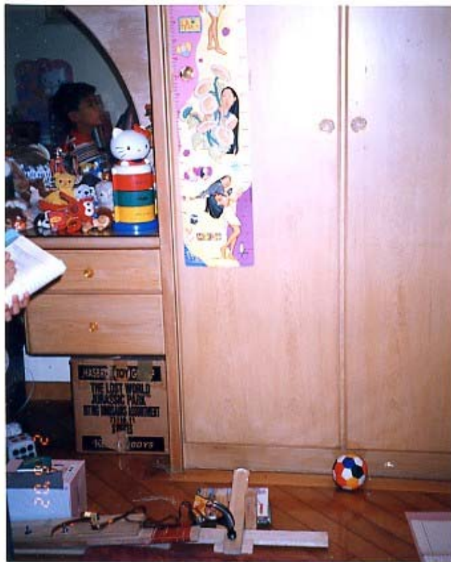
【照片 9】看球彈升的高度：背景卡通身高尺圖案加布尺，這次實驗過程發現，可以先看球到圖畫的哪一部位，再找尺的高度，更準確性的讀出球的高度。
