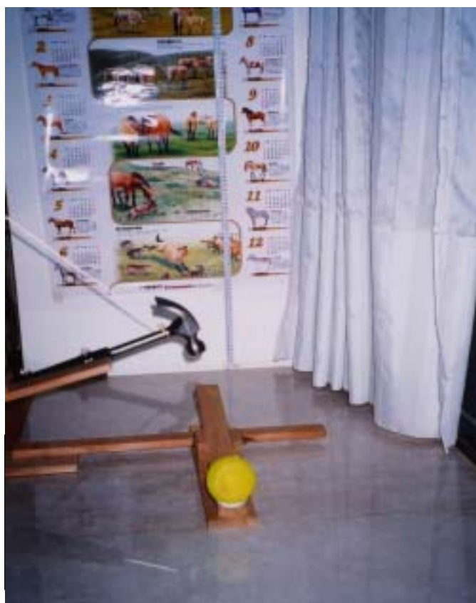
【照片 1-3-6】施力點靠近尺，球彈升時離尺較遠，觀察較不容易。
