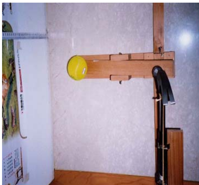
【照片 1-3-7】受力點靠近尺，較容易觀察球彈升高度。
