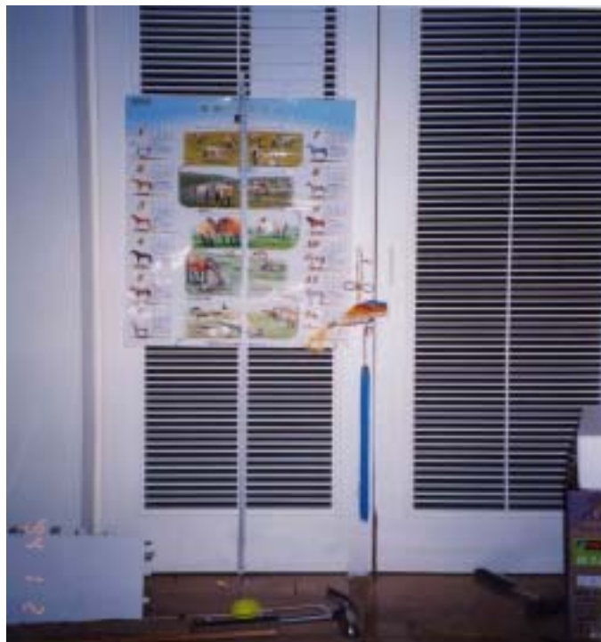
【照片 10】看球彈升的高度：背景圖案加布尺加自繪格子，經由每一次實驗過程發現可以更準確性的讀出球的高度。
