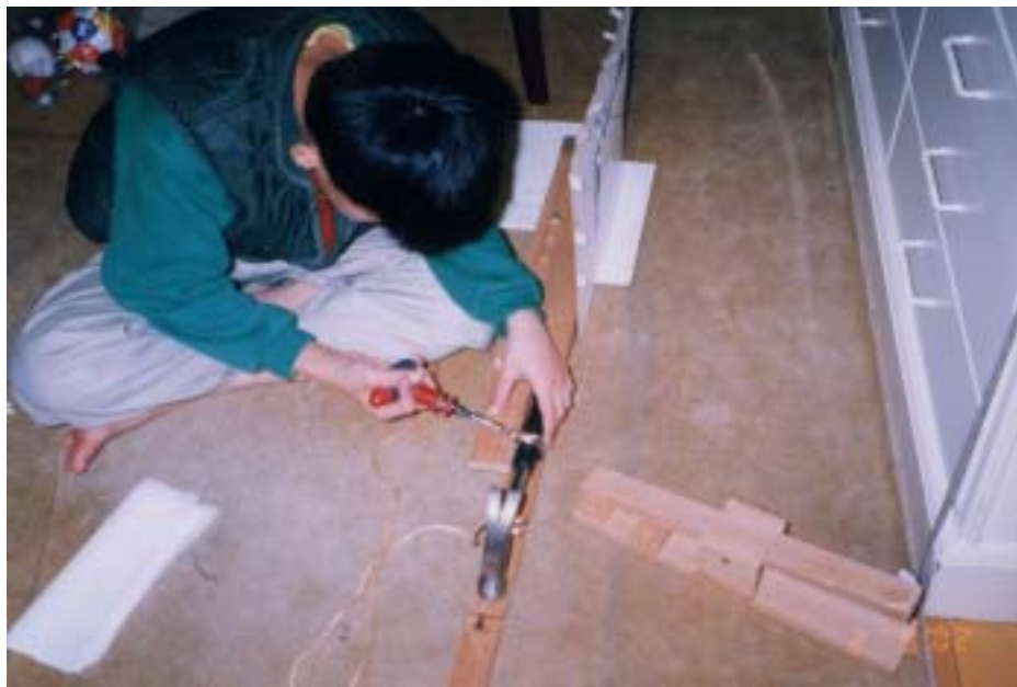
【照片 6】用扣環將鎚子固定在木板上，改善繩子纏繞，敲擊數次後容易鬆脫；做一個橫桿可替換不同長度的受力臂、施力臂。
