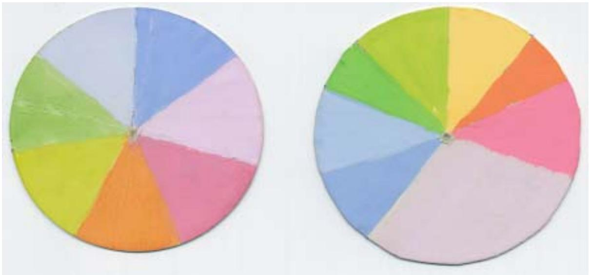
【實驗五】七等分的牛頓盤調配成較淡顏色，旋轉時變成白色
