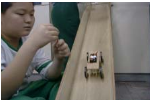
測試有胎紋車子的爬坡狀況。
