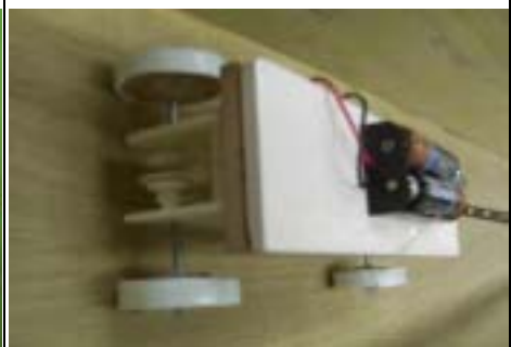
車板上黏相同尺寸磁磚，測試車輛平均載重。
