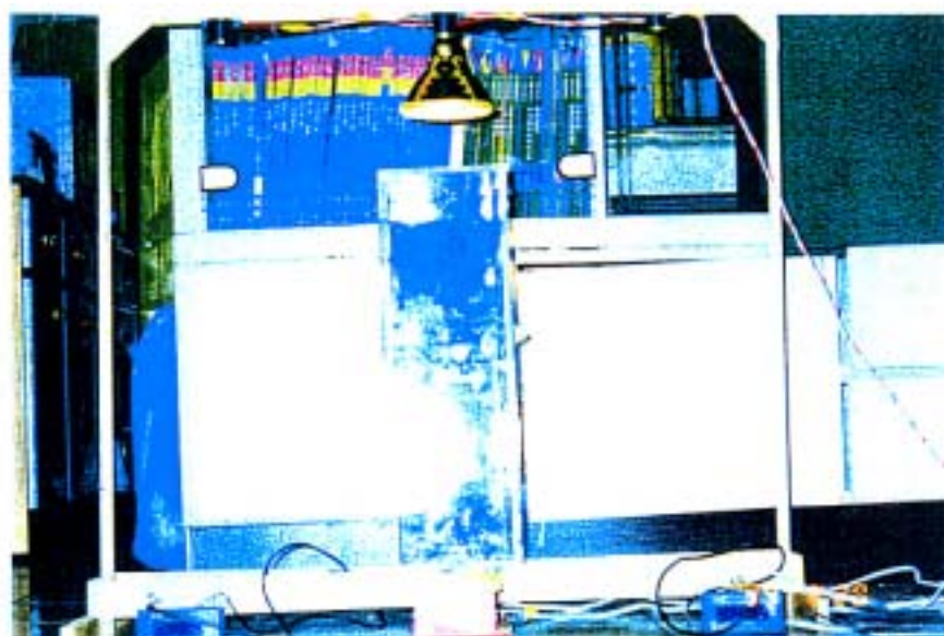
形。 箱頂開孔散熱、室外熱源照射情
