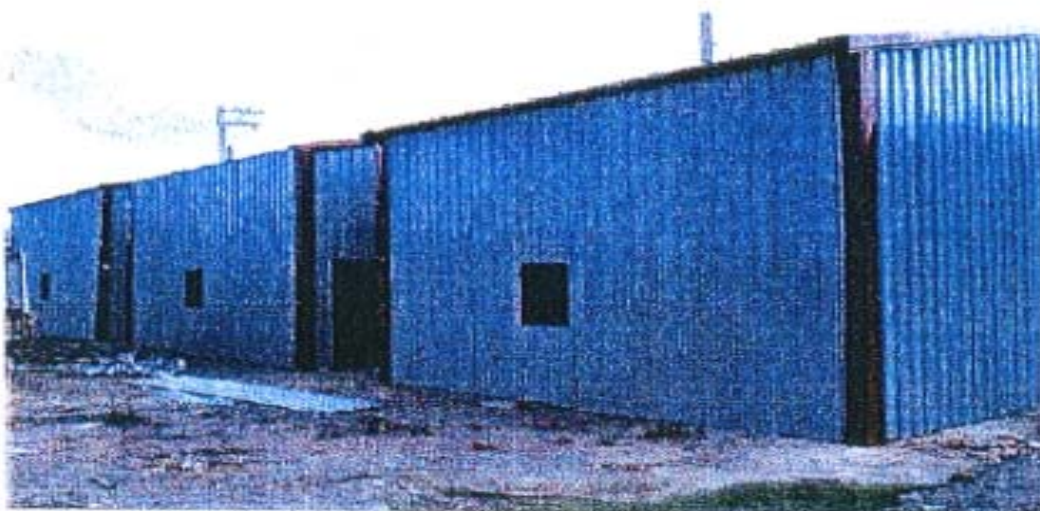
測試屋安排由左而右為 散熱屋頂浪板、一般浪板及 PU 浪板
