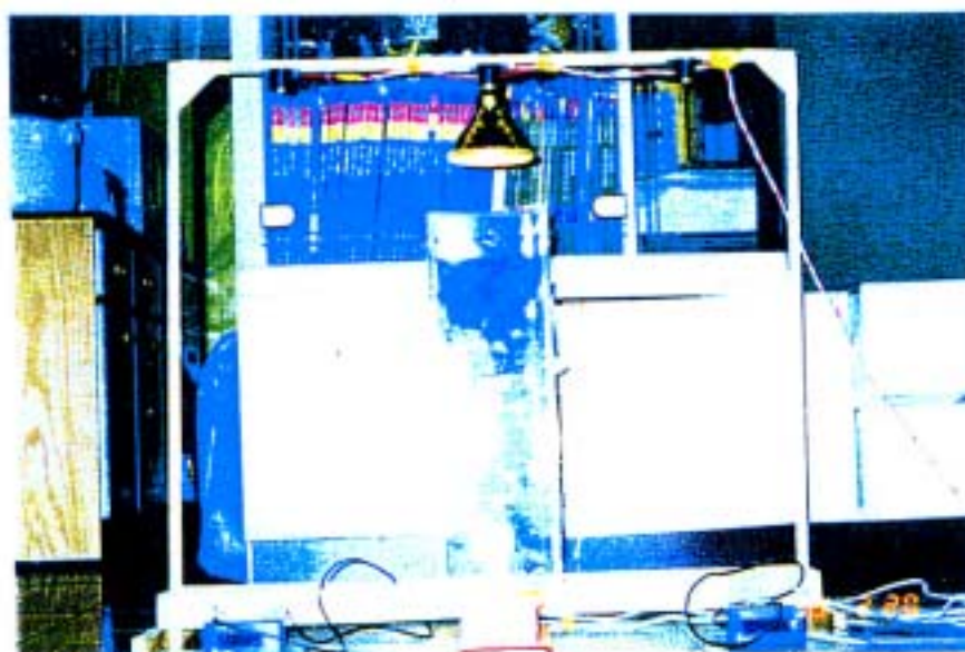
時供熱情形。 箱頂開孔散熱、室內、外熱源同
