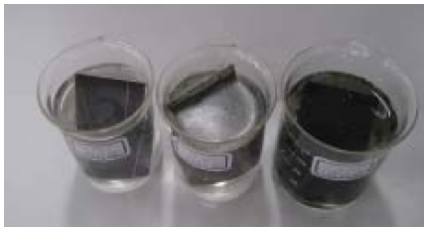
(圖 11.)鍍鋅鐵塗布 PANi-EB、PANi-ES 浸於 1.0MHCl 3 分鐘後，顯示表面鋅立即與鹽酸起反應，但內部鐵得到保護。
