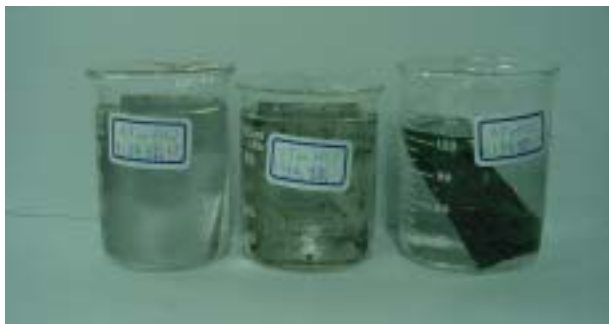
(圖 3.)純鐵塗布 PANi-EB、PANi-ES 浸於 0.5MHCl 3 分鐘後，顯示兩者附著力都很好。
