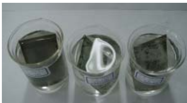
(圖 8.)不鏽鋼 SS304、鍍鋅鐵、純鐵塗布 PANi-EB 浸於 3% NaCl 3 分鐘後，顯示三者都算良好。
