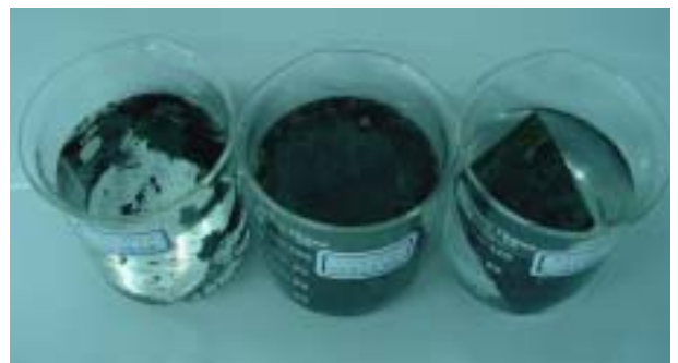
(圖 4.)不鏽鋼 SS304、鍍鋅鐵、純鐵塗布 PANi-ES 浸於 0.5MHCl 3 分鐘後，顯示純鐵附著力最好。
