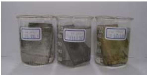
(圖 14.)不鏽鋼 SS304、鍍鋅鐵、純鐵塗布 PANi-ES 浸於 1.0MHCl 3 分鐘後，顯示三者附著力都不好。
