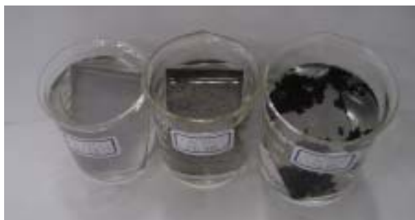
(圖 12.)純鐵塗布 PANi-EB、PANi-ES 浸於 1.0MHCl 3 分鐘後，顯示 PANi-EB 附著力較好。
