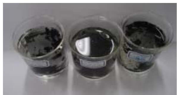
(圖 14.)不鏽鋼 SS304、鍍鋅鐵、純鐵塗布 PANi-ES 浸於 1.0MHCl 3 分鐘後，顯示三者附著力都不好。
