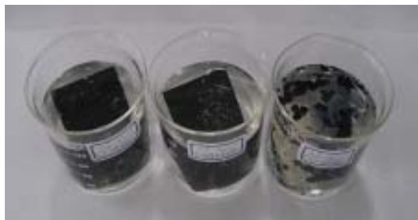
(圖 9.)不鏽鋼 SS304、鍍鋅鐵、純鐵塗布 PANi-ES 浸於 3% NaCl 3 分鐘後，顯示不鏽鋼最差。
