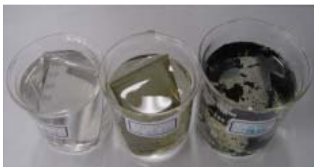
(圖 10.)不鏽鋼 SS304 塗布 PANi-EB、PANi-ES 浸於 1.0MHCl 3 分鐘後，顯示 PANi-ES 附著力最差。
