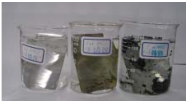
(圖 10.)不鏽鋼 SS304 塗布 PANi-EB、PANi-ES 浸於 1.0MHCl 3 分鐘後，顯示 PANi-ES 附著力最差。
