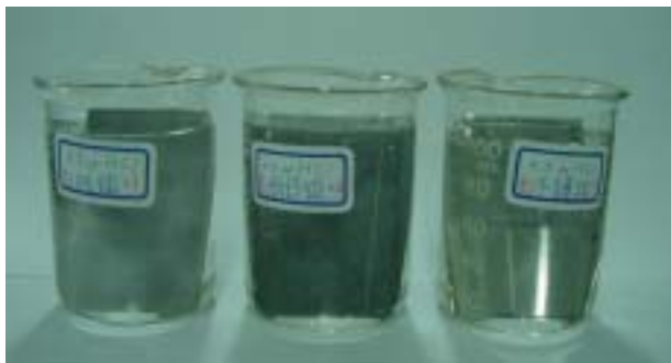
(圖 6.)不鏽鋼 SS304、鍍鋅鐵、純鐵浸於 0.5MHCl 3 分鐘後，顯示不鏽鋼耐腐蝕力最好，鍍鋅鐵最快反應，但內部鐵得到保護。
