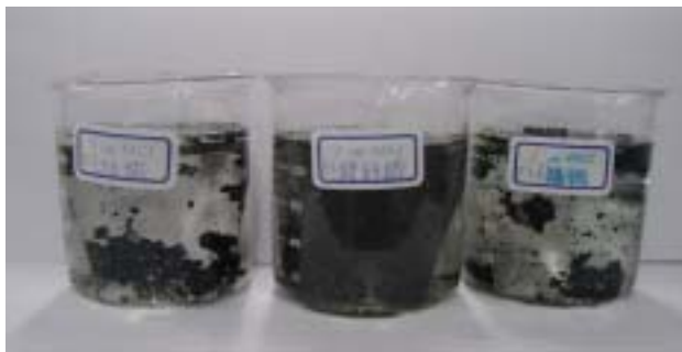
(圖 14.)不鏽鋼 SS304、鍍鋅鐵、純鐵塗布 PANi-ES 浸於 1.0MHCl 3 分鐘後，顯示三者附著力都不好。
