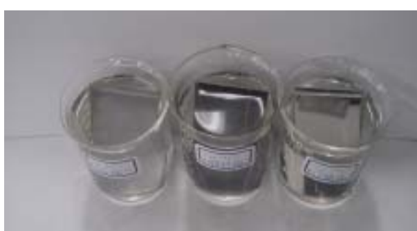
(圖 13.)不鏽鋼 SS304、鍍鋅鐵、純鐵浸於 1.0MHCl 3 分鐘後，顯示不鏽鋼耐腐蝕力最好，鍍鋅鐵最快反應，但內部鐵得到保護。
