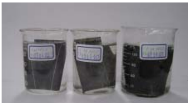
(圖 11.)鍍鋅鐵塗布 PANi-EB、PANi-ES 浸於 1.0MHCl 3 分鐘後，顯示表面鋅立即與鹽酸起反應，但內部鐵得到保護。
