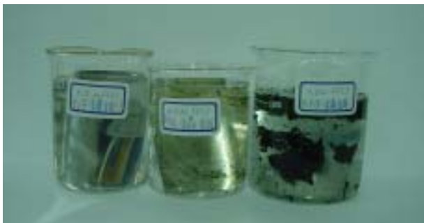
(圖 1.) 不鏽鋼 SS304 塗布 PANi-EB、PANi-ES 浸於 0.5MHCl 3 分鐘後，顯示 PANi-ES 附著力最差。
