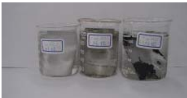
(圖 12.)純鐵塗布 PANi-EB、PANi-ES 浸於 1.0MHCl 3 分鐘後，顯示 PANi-EB 附著力較好。
