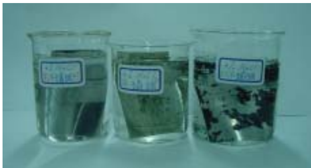
(圖 7.)不鏽鋼 SS304 塗布 PANi-EB、PANi-ES 浸於 3% NaCl 3 分鐘後，顯示 PANi-ES 附著力最差。
