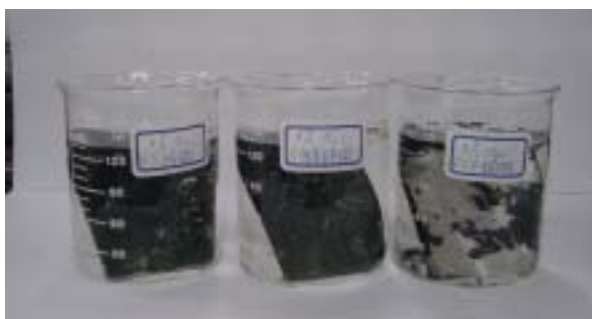
(圖 9.)不鏽鋼 SS304、鍍鋅鐵、純鐵塗布 PANi-ES 浸於 3% NaCl 3 分鐘後，顯示不鏽鋼最差。
