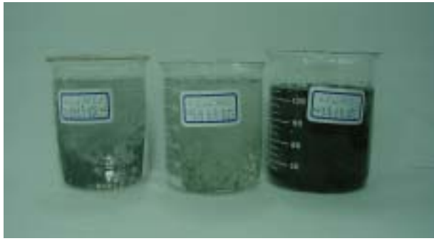
(圖 2.)鍍鋅鐵塗布 PANi-EB、PANi-ES 浸於 0.5MHCl 3 分鐘後，顯示表面鋅立即與鹽酸起反應，但內部鐵得到保護。
