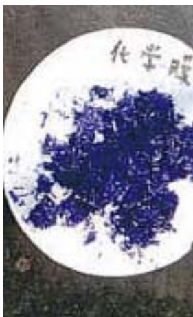
照片(十五) 左照片為化學膜培養的晶體，針狀晶體及粉末參雜，粉末的量較多，與濾紙法的結果相似。
