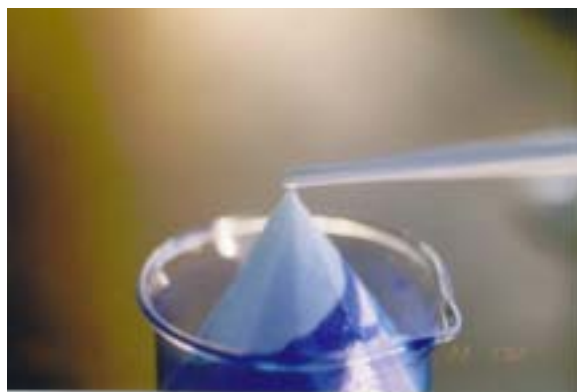
照片(三) 濾紙法(圓錐狀)的實驗操作
