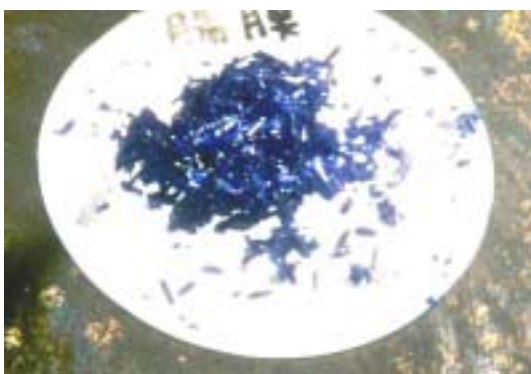
照片(十六) 左照片為豬腸膜法培養出的晶體，針狀晶體的量多，實用性頗高。
