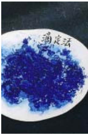
照片(十三) 此為「滴定管法」所培養的晶體形狀，大多為粉末狀，並無完整晶形。
