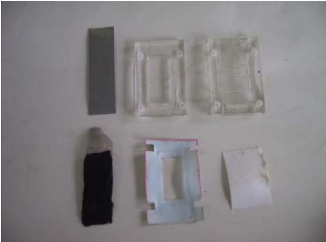
圖 2 組裝前的電池零件
