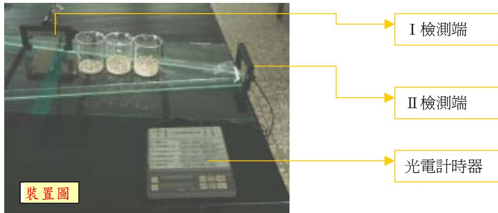
4. 為不使 II 檢測端受到玻璃條的阻擋，我們將玻璃條的最前端控制在玻璃板的範圍內而不凸出。黏貼角度板時，將已畫好  $4n$ 、 $6n$ 、 $8n$  的開口標記線水平對齊桌緣，而玻璃條就順著張角的兩邊貼齊（如此就可以控制開口大小並能使玻璃條不凸出）。最後將投影紙角度板的尾端反粘至尾端以避免干擾 BB 彈流動。
