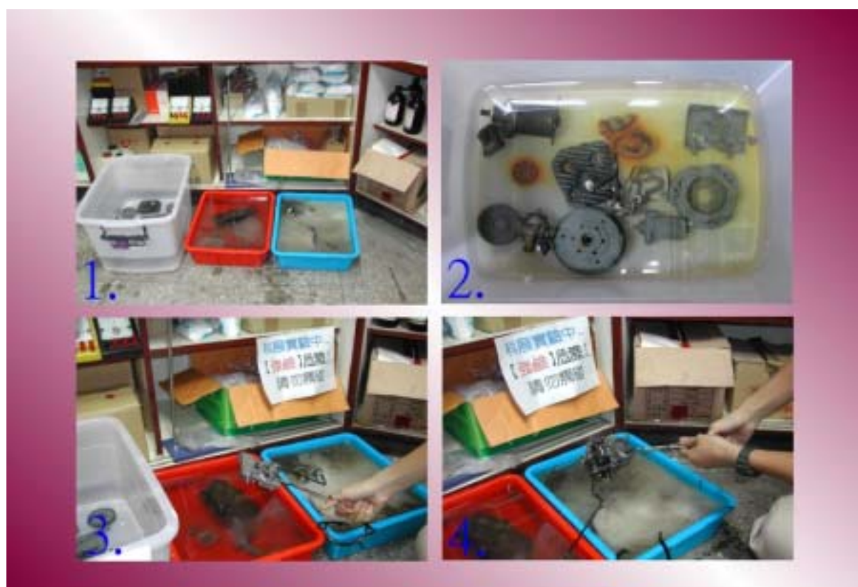
圖十、機車零件浸泡於水、強酸、強鹼中
