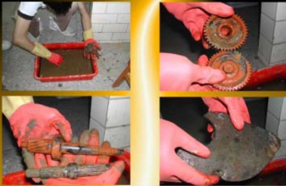
圖十二、機車零件浸泡於基隆河水中之生鏽圖
