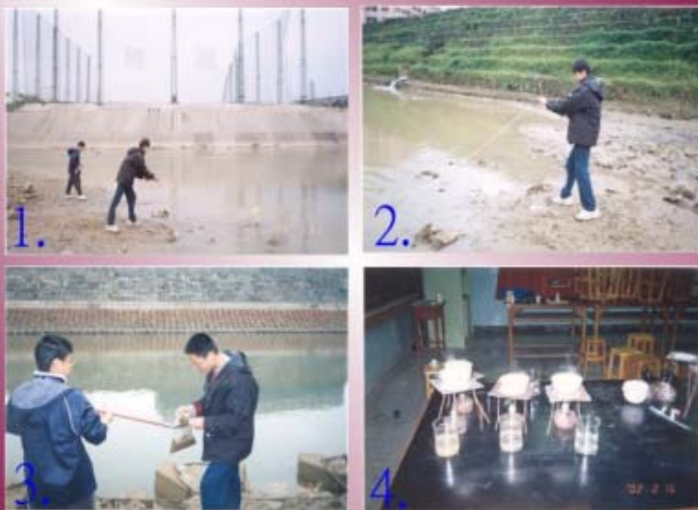
圖二、基隆河取水與蒸發法實驗過程
