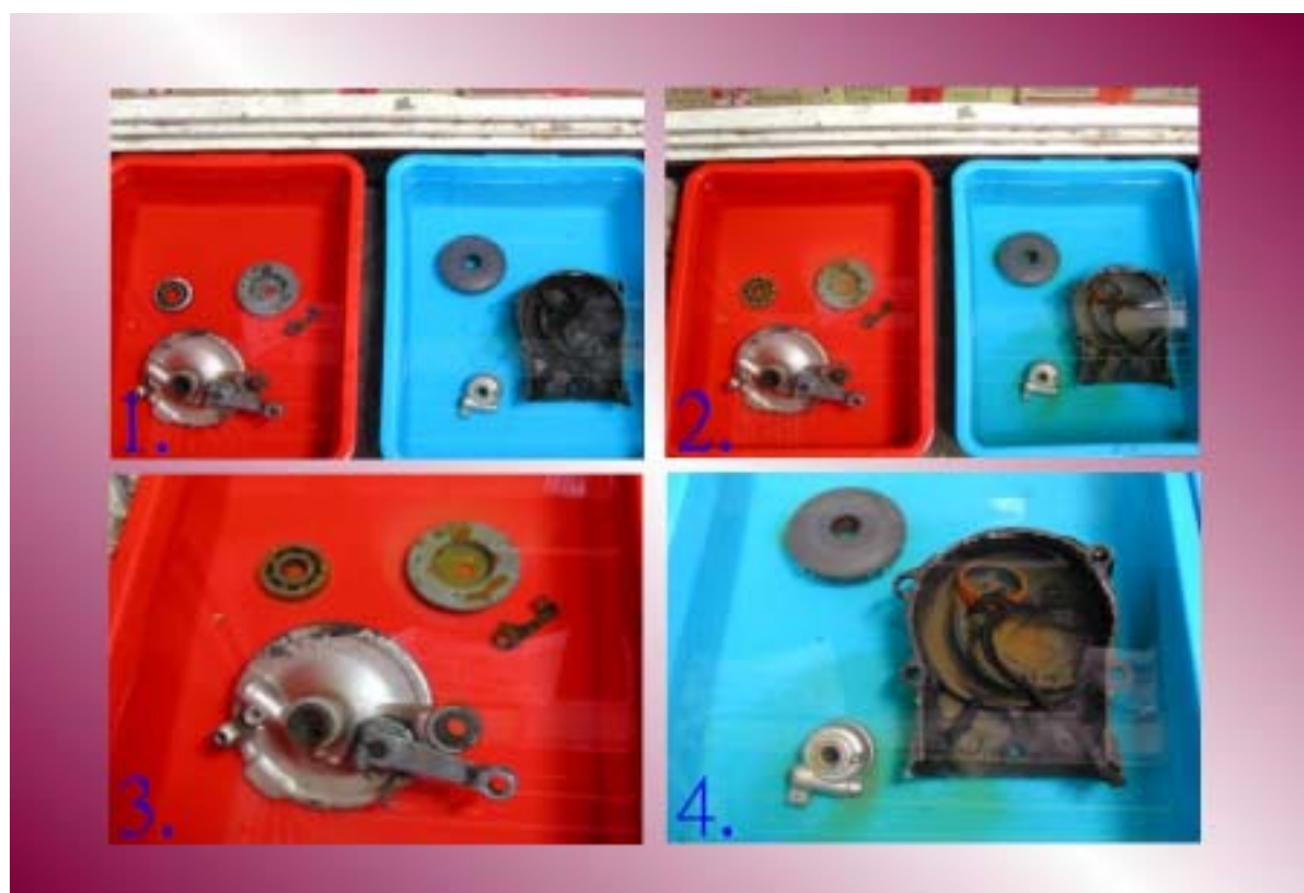
圖十一、機車零件浸泡於於弱酸、弱鹼中
