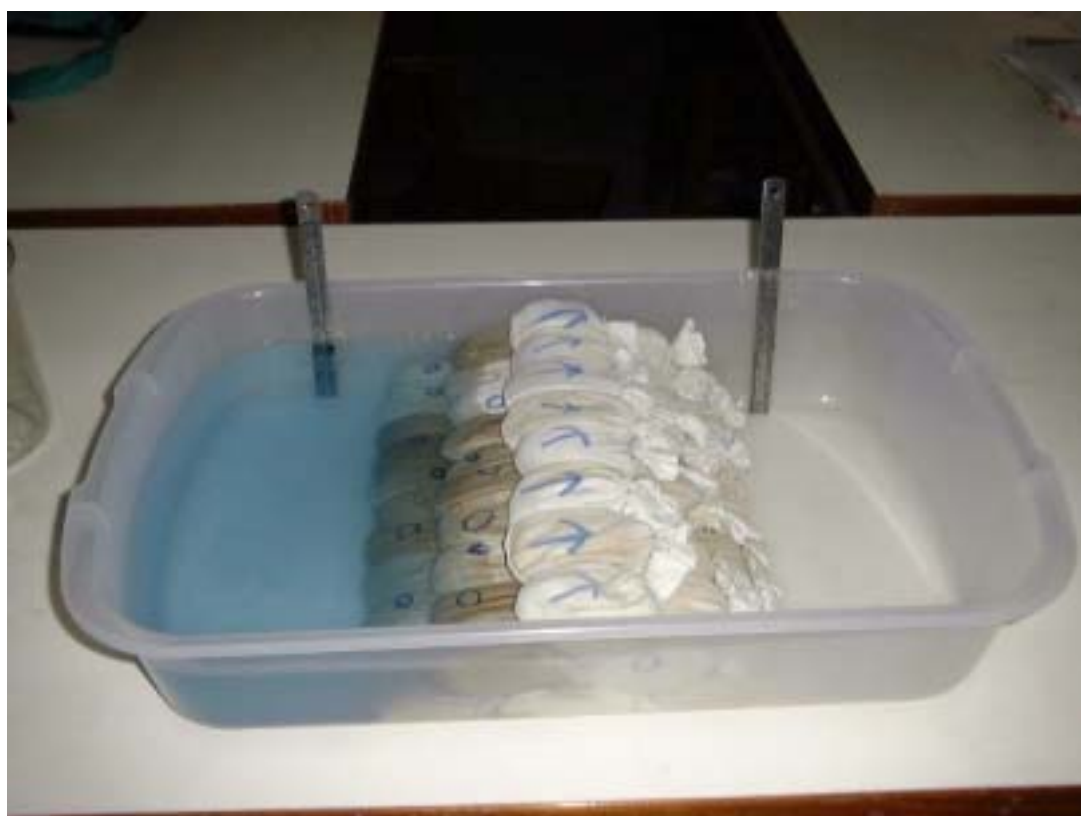
照片四 排列 P(S)---金字塔排列及高水位的水
