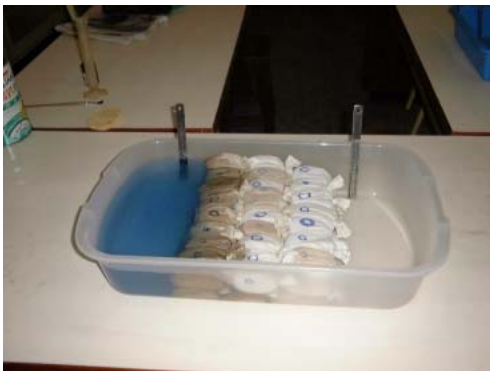
照片六 排列 SSS---非金字塔排列及高水位的水
