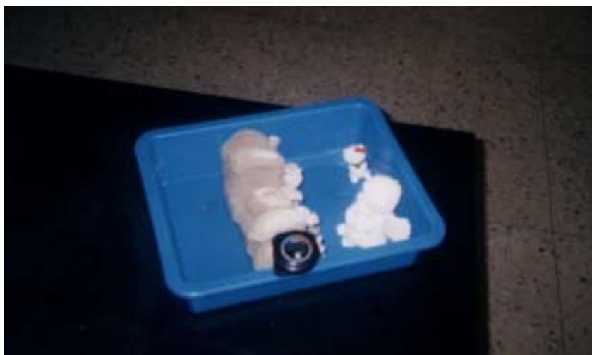
照片三 實驗中(觀察滲水狀況)
