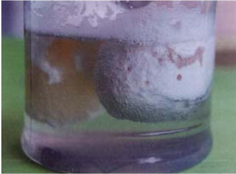
圖 60 雞蛋浸漬在  $\text{pH}=1.3$ ，蛋殼就有看到氣泡冒出，蛋殼慢慢地被腐蝕，氣泡不斷往上聚集，下層清澈
