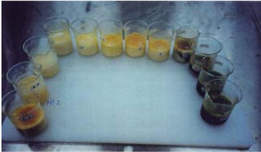
圖 55 液全蛋調整不同 pH 值為，加熱 80 ℃、30 分鐘後之外觀
