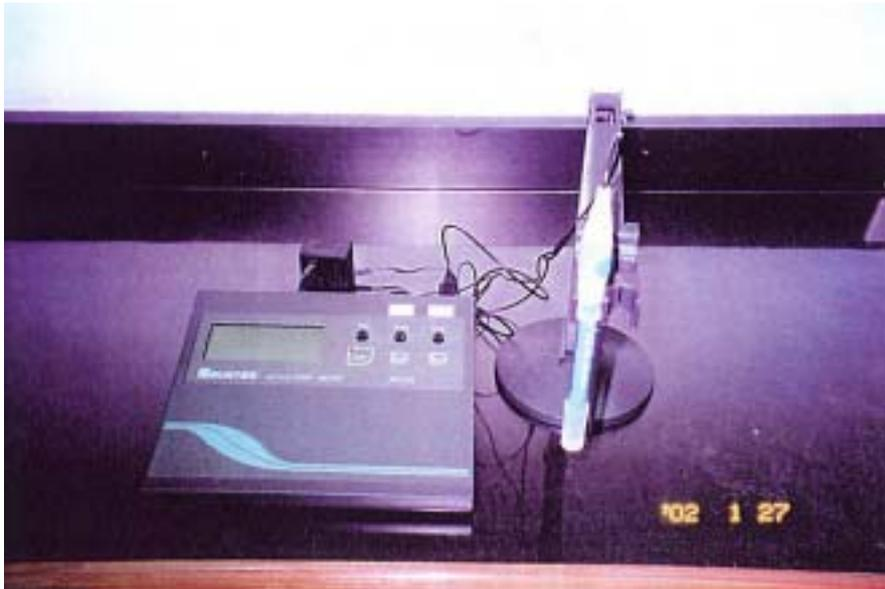
圖 73 pH 測定儀 ( pH/mv/TEMP. METER )
