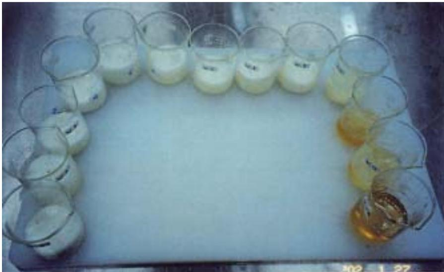
**圖 54** 液蛋白調整不同 pH 值為，加熱 80 °C、30 分鐘後之外觀
