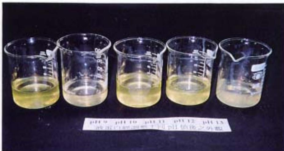
圖 12 pH 值為鹼性時，顏色接近原蛋白，且上層乳濁狀蛋白不見，pH12、13 時呈半透明凝膠狀，不流動，產生蛋白鹼性凝膠
