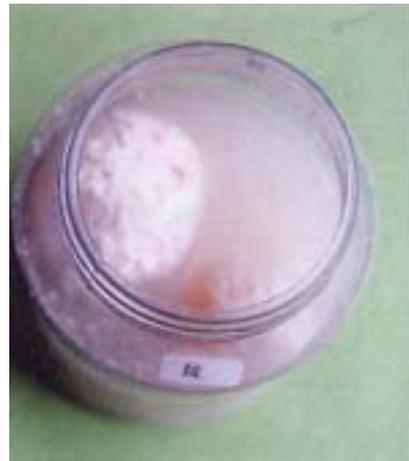
圖 62 蛋殼被腐蝕更多，氣泡逐漸消失，溶液有白色碳酸鈣混濁
