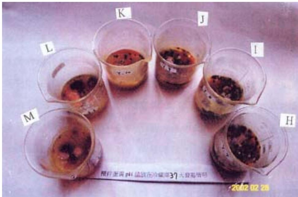
圖 70 液蛋黃調整 pH 值 ( H : pH7 ; I : pH8 ; J : pH9 ; K : pH10 ; L : pH11 ; M : pH12 )
