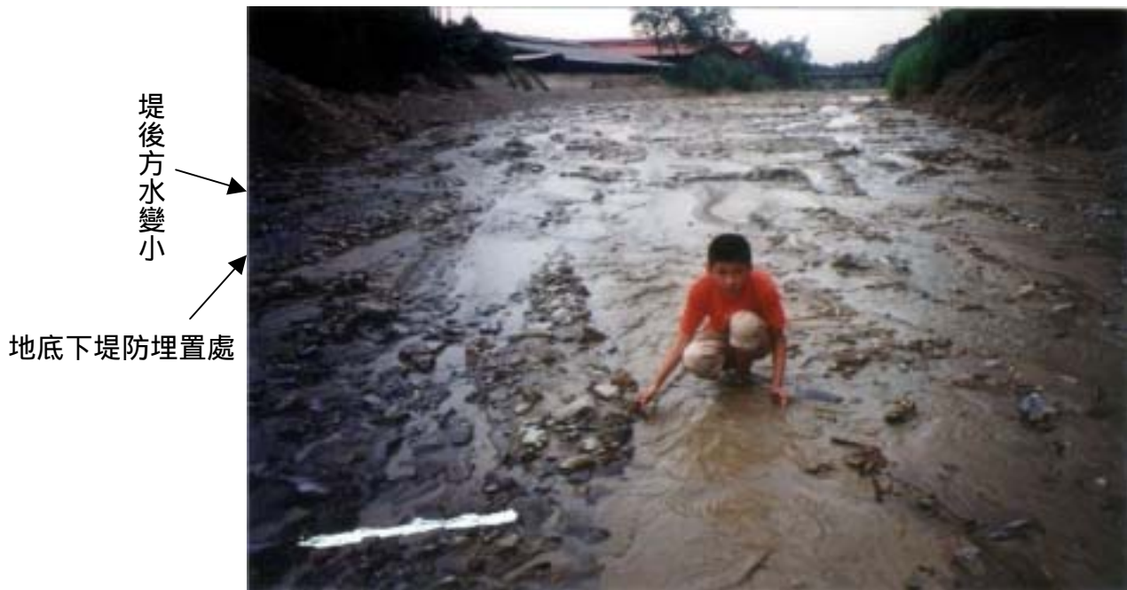
圖十四 地下堤防實地實驗圖
