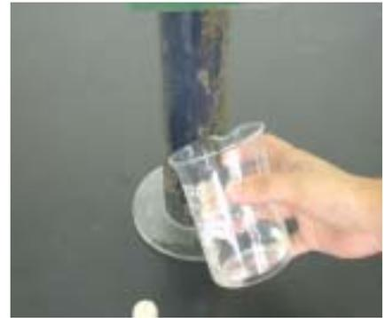
裝各砂石層的側漏水壓比較管 量測至第三孔的溢水時間 撤第二孔塞子時的出水量及時間
