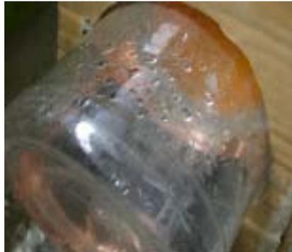
水蒸氣在圓筒壁頂凝結成水滴
