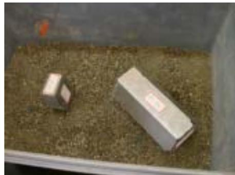
模擬各建物質質量在下壓不同接觸面積下，所導致地層下陷及不穩定(建物傾斜)的實驗
