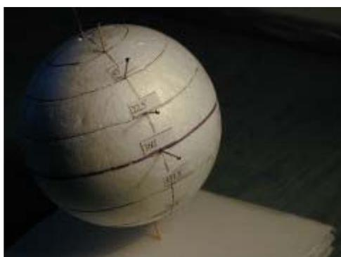
實驗一：探討晷針在不同緯度與地平面垂直時影子變化的情形
