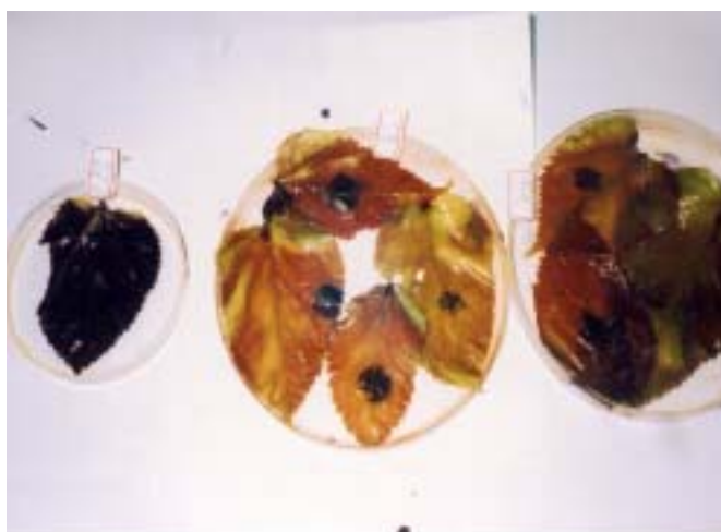
照片 29：測量不同碘液 濃度之染色效果
