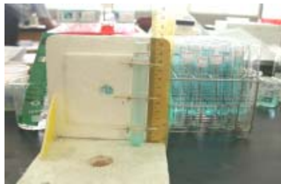
自製高度測量座測沉澱物的高度
