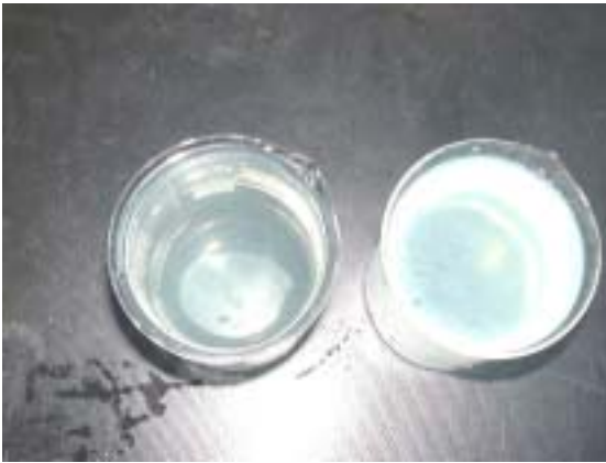
5 分鐘後由正極(左杯)及負極(右杯)流出的電解液
