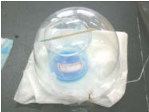
硫酸銅的光能結晶の晶種生成法
