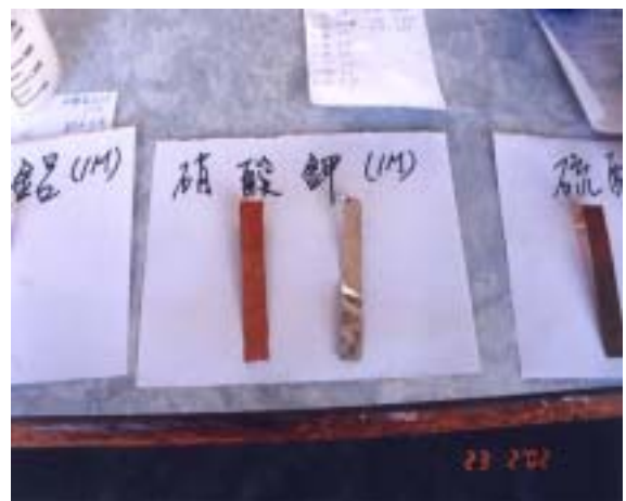
圖 1-5 兩電極被腐蝕的情況並不明顯。
