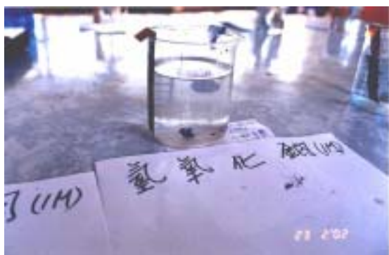
圖 1-2 掉落至電解質的鋁 電極產生氫氣。
