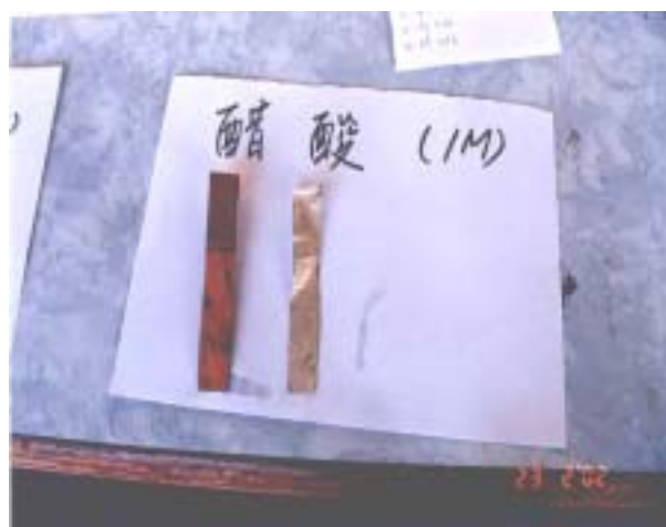
圖 1-15 兩電極被腐蝕的情況並不明顯。
