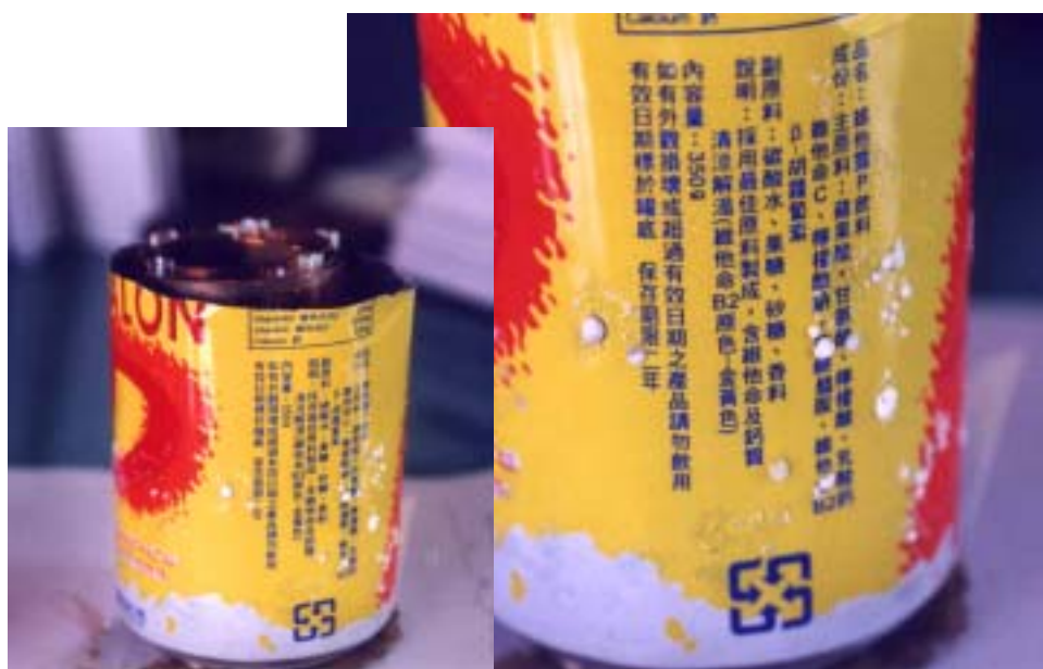
圖 2-9 鋁罐外壁析出之白色固體。
