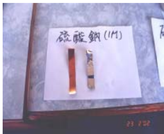
圖 1-9 兩電極被腐蝕的情況 並不明顯。
