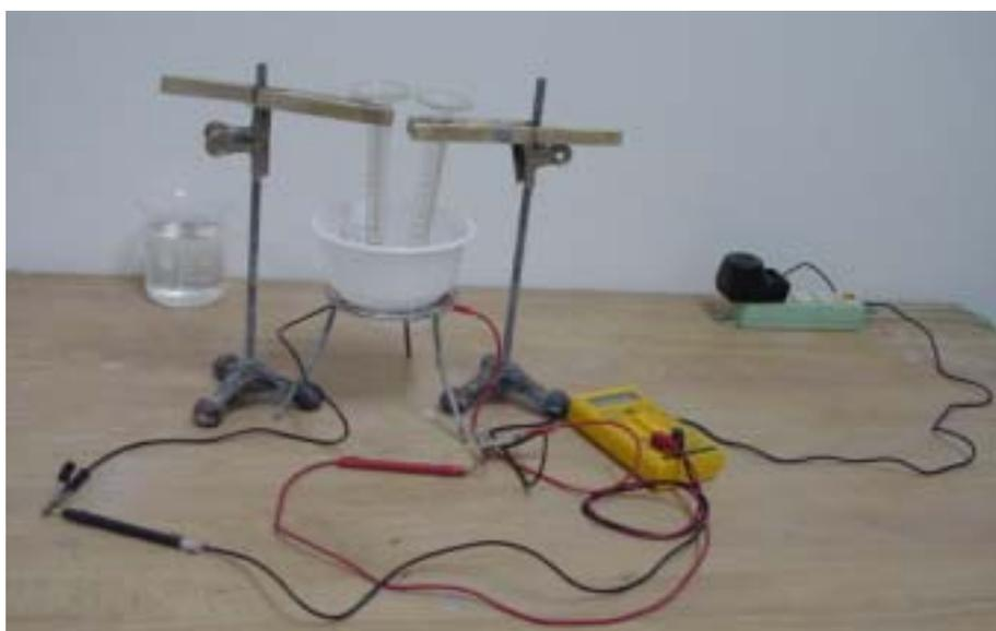
2.結果： 電壓 6V，NaOH 30 % 電解時間：10 分 電極棒長度 2.5 cm 寬度 2 mm。
