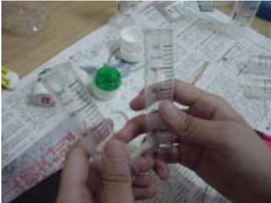
裝上 T 型管連接，以 AB 膠固定。
