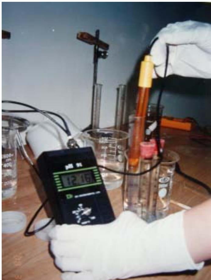
利用 PH 測試儀量正負極電解液的 PH 值
