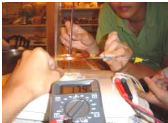
照片（二）：線圈與電磁爐之距離與感應電壓之關係
