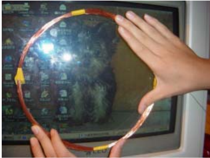
照片（九）：測量電腦螢幕附近之電磁波
