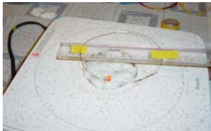
圖(十四)-1: 以“無接點”裝置遠距離推動發光二極體(較近距離)
