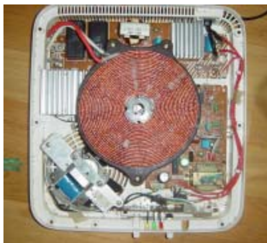
照片（十二）：電磁爐之內部構造
