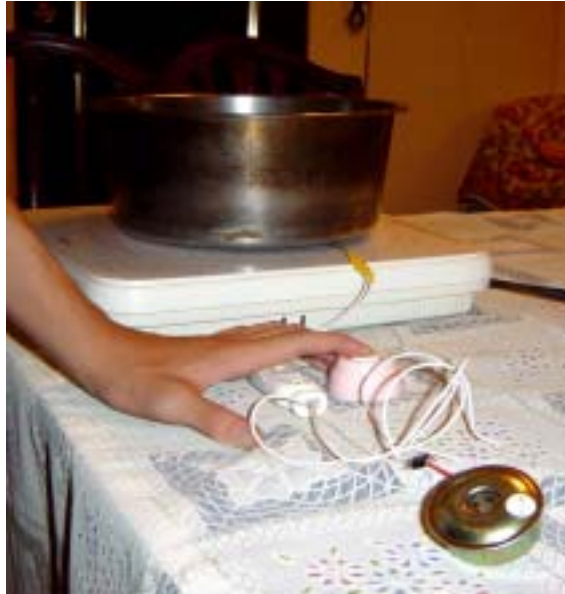
照片(十三)-1:以“無接點”裝置成功推動蜂鳴器(以二極體整流)
