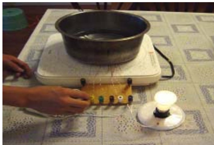
照片 (十一) -1：驗證感應電壓隨線圈匝數增加而上升(5 匝)
