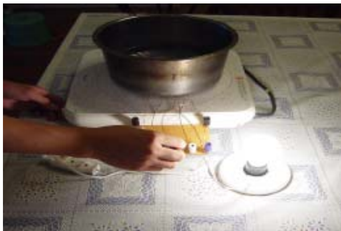
照片（十一）-2：驗證感應電壓隨線圈匝數增加而上升(15 匝)
