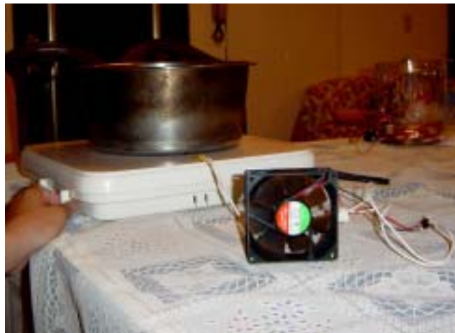
照片(十三)-2:以“無接點”裝置成功推動風扇(以二極體整流)
