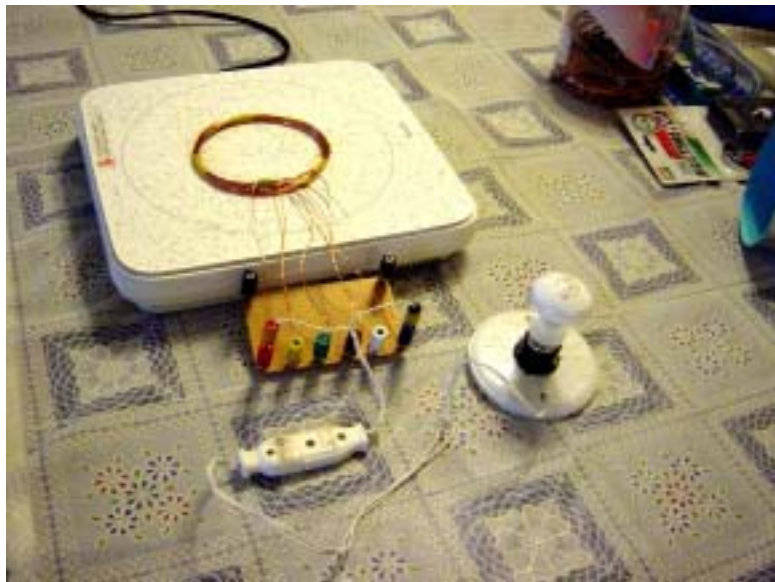
照片 ( 一 ) : 驗證感應電壓隨線圈匝數增加而上升之簡易裝置。
