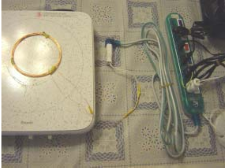
照片（七）：嘗試使用“無接點”裝置推動電器
