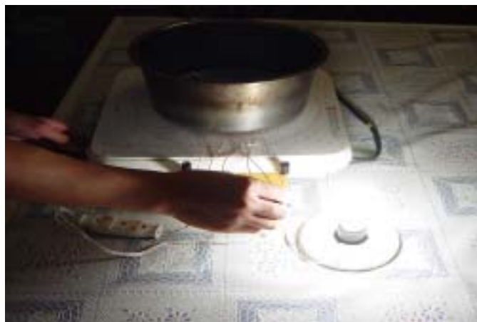
照片（十一）-3：驗證感應電壓隨線圈匝數增加而上升(25 匝)
