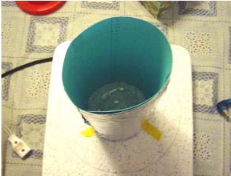
照片（五）：“屏蔽”裝置俯視
