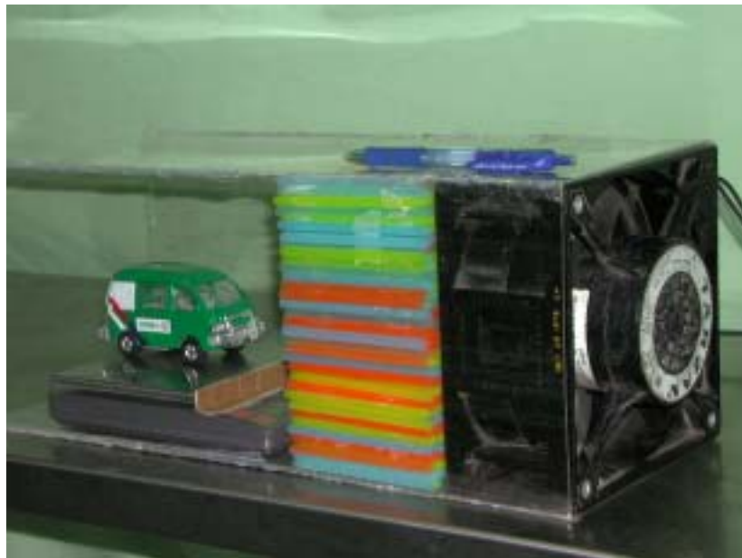
風洞之側視圖（整流段、動力段）
