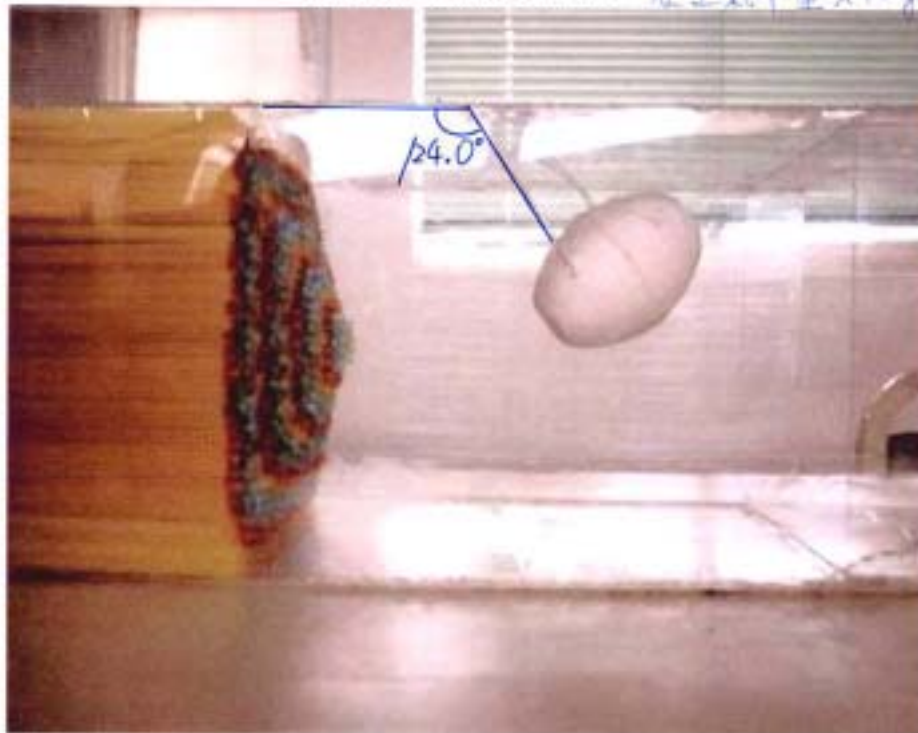
保麗龍蛋 (風扇電壓 90V) F_{\text{水平}} = 340 \times \tan(124.1^\circ - 90^\circ) \div 2.30 \text{ gw}
