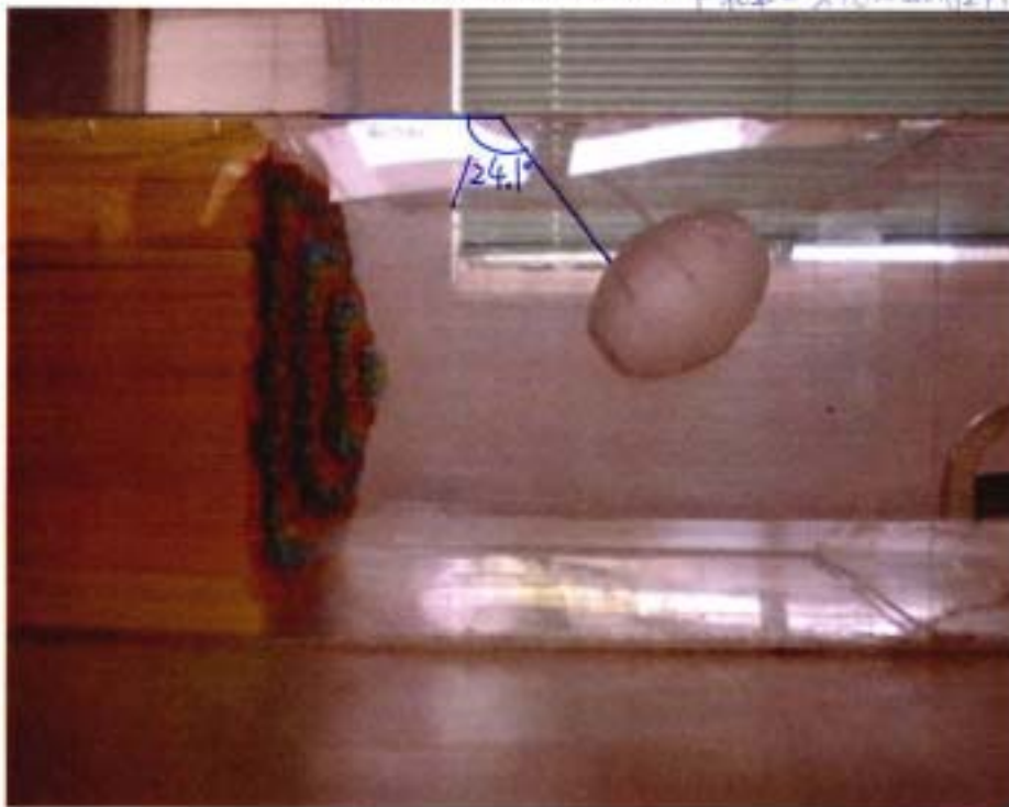
保麗龍蛋 (風扇電壓 90V) F_{\text{水平}} = 340 \times \tan(124.1^\circ - 90^\circ) \div 2.30 \text{ gw}
