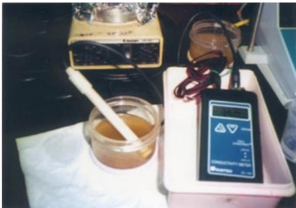
照片 12：用檢測計檢測樣本液的導電度
