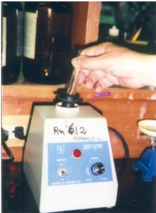
照片 10：冷卻後，第二次離心處理，倒去澄清液，加水 5c.c.，震盪。
