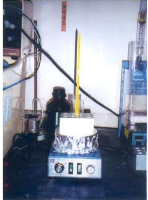
照片 9：將試管加熱至  $100^{\circ}\text{C}$  後，煮十分鐘。
