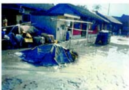
圖四、地震後產生土壤液化之噴砂現象
