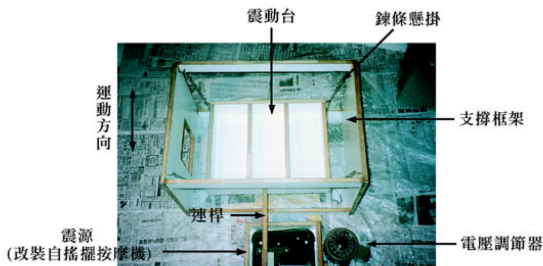
圖一、改良後震動台之真實照片；震源連桿帶動震動台進行運動，並由電壓調節器控制其震動快慢程度。
