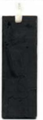
圖三 壓克力基材的碳膜-鉑粉電極
