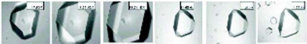
由圖中可看出：晶體邊長的成長速率是越來越慢的。剛開始的成長速率很快，成長速率每分鐘約17.5 微米，可能是由於此時溶液過飽和析出的明礬分子很多，但同時在成長的晶體並不很多，因此各個晶體可以大量吸收分子快速成長。但是到了11:31時，邊的成長速率每分鐘只有 3.5 微米，到了11:37時，邊的成長速率變得更慢了，每分鐘只長了 3 微米，可能是由於越到後期，同時成長的晶體越多，爭食明礬分子的結果，使得大家都長得很慢。
