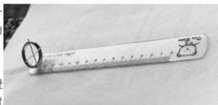
圖（一）：自製濁度計。
