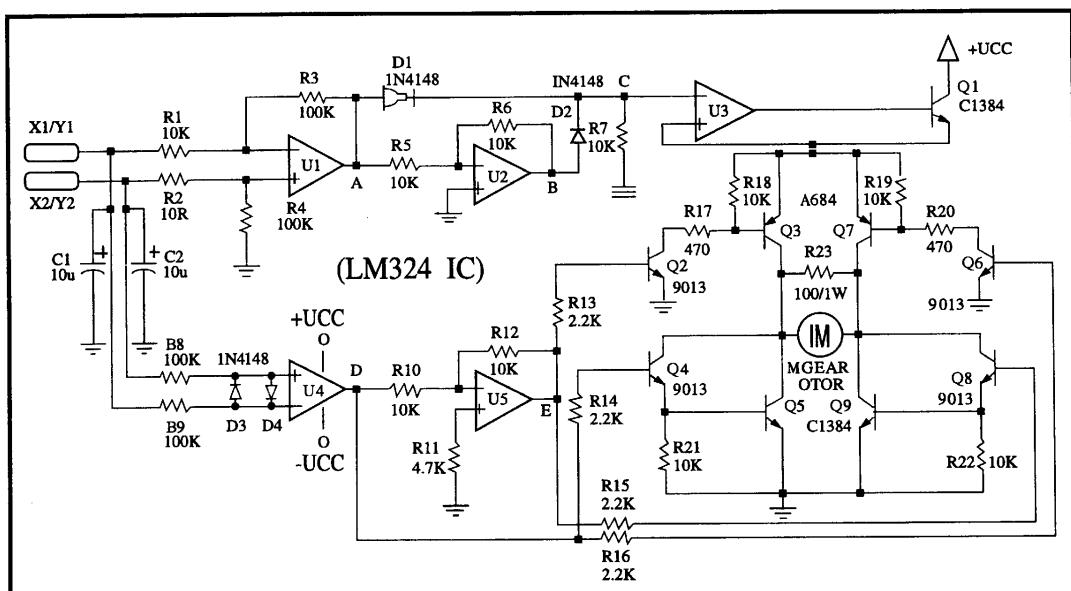
$X_1$ 、 $X_2$ 分別輸入由光感測裝置內，水平軸向取樣電壓輸出端，並經由  $R_1$ 、 $R_2$ 、 $R_3$ 、 $R_4$ 、 $U_1$  所組成的差值放大電路。其運算動態如下：
