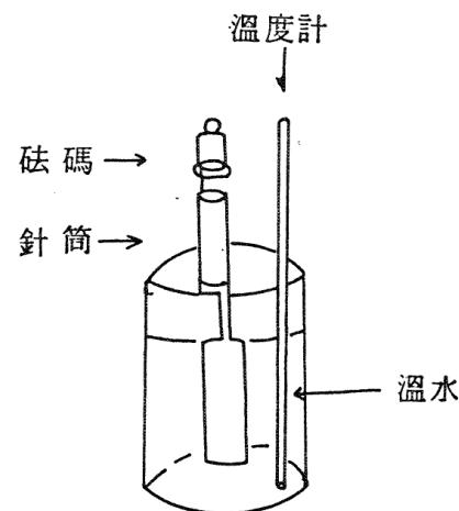
發現：(1)用 5cc 針筒實驗，溫度高時針筒移動太快，超出針筒長度，熱空氣會跑出來。
