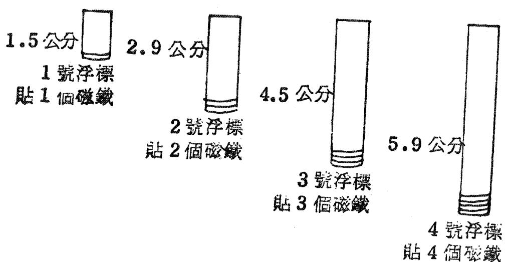
發現：1. 浮標較長的上升較高（我們認為在水中重量相同時，長的浮標磁鐵較多，所以推力較強。）
