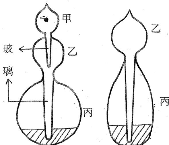
構造有好幾種，一般以上列二種為常見，第A種分甲、乙、丙三部分，甲乙之間，乙丙之間有玻管相通且甲乙間的玻管到底乙之底端，乙丙間之玻管，到底丙之底端浸入液中。第B種只分乙、丙兩部分，乙、丙間有玻管連接。
