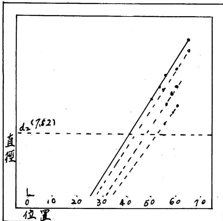
(四)  $r_1$  組表中，各線之交點表點光源之位置，各線分別與  $d_1$  交於  $B_{1(1)}, B_{1(2)}, \dots$ 。 $r_2$  組表中，各線與底線之交點表虛光源之位置，其與  $B_{2(1)}, B_{2(2)}, \dots$  之距即爲
