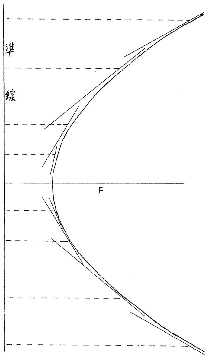
⑤再以 F 為定點依②③④的方法找出第二點，以此類推可以找出無數點，再以平滑曲線連接即成爲拋物線如完成圖。
