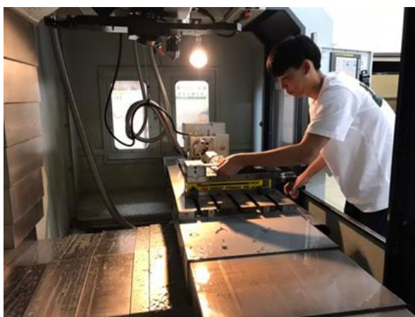
學生操作 CNC，加工作品零件。
