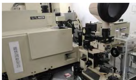
圖 13. 拉曼光譜實驗所採用的 JY 光譜儀。
