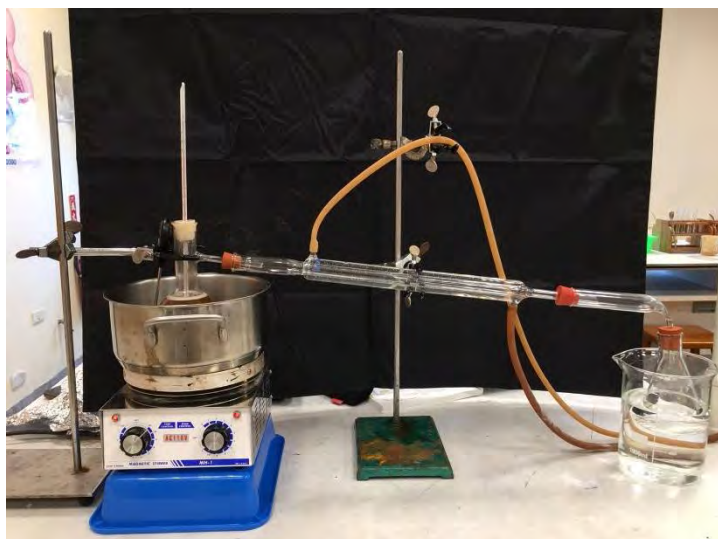
圖 17. 以蒸餾法萃取川七零餘子粉末抗菌物質裝置圖。
