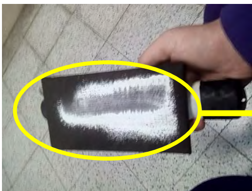
圖十七、未通電第二代靜電板擦實驗後照片
