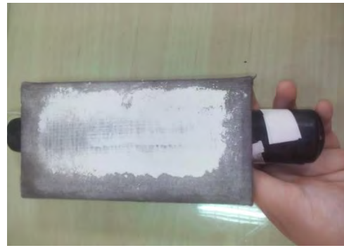
圖十二、未通電第二代板擦擦完黑板照片
