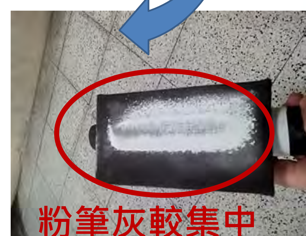
圖八、通電第二代靜電板擦實驗後照片
