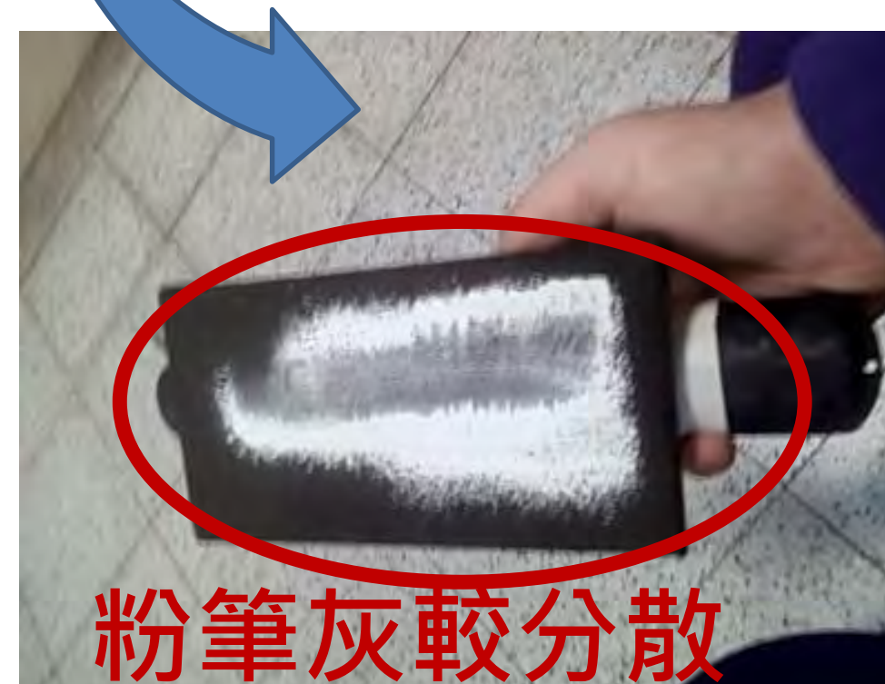
圖七、未通電第二代靜電板擦實驗後照片
