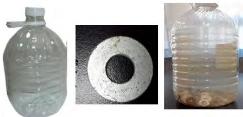
▲圖10：人工製造波浪的寶特瓶，並以鐵環增加重量(放在大桶子中的樣子)
