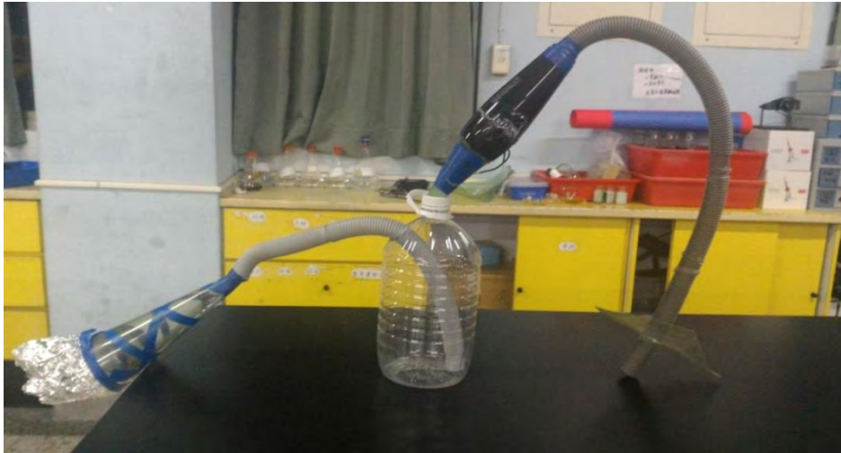
圖三：第一代油煙淨化裝置
