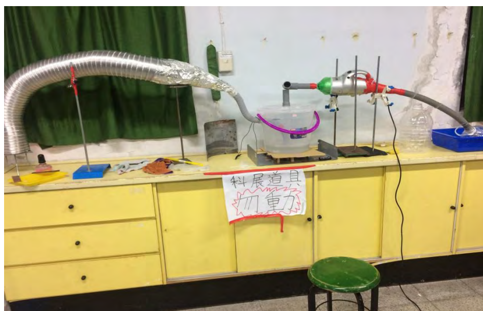
圖七：第三代裝置修正圖，風扇馬達與淨化桶的連結
