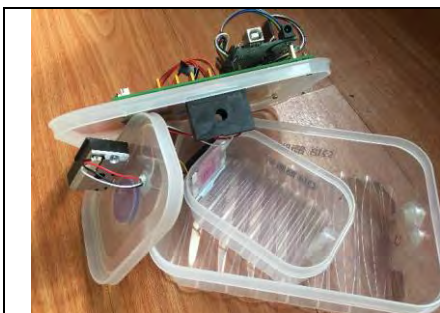
圖42 內外測試盒與PM2.5傳感器
