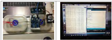
圖23 利用自製循環即時裝置偵測果皮濾心吸附PM2.5
