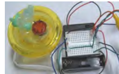
圖18 自製氣體偵測儀器
