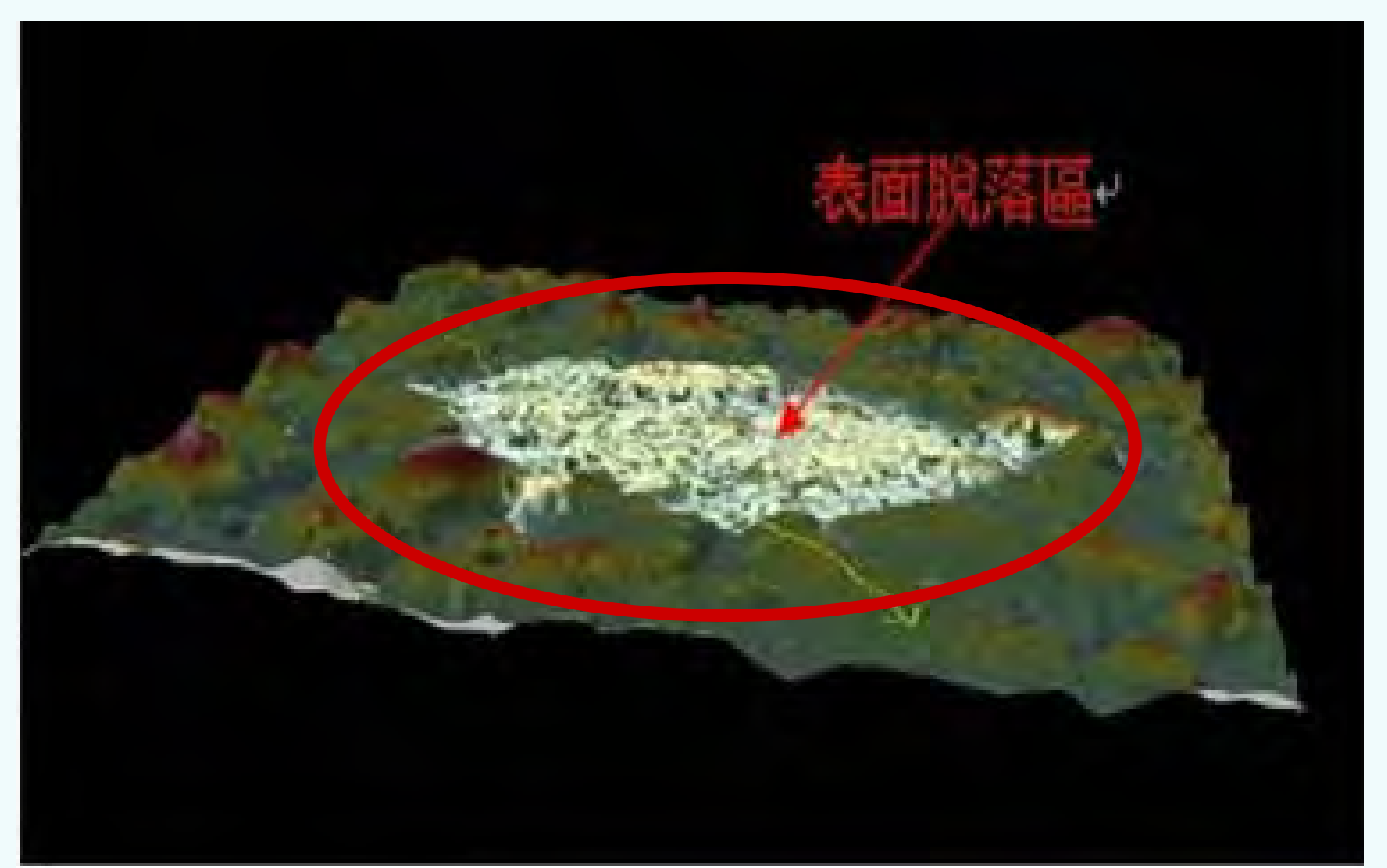
圖15 石墨層產生『脫落』現象
