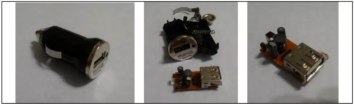
圖 6 汽車充電器拆開的板子小小的
