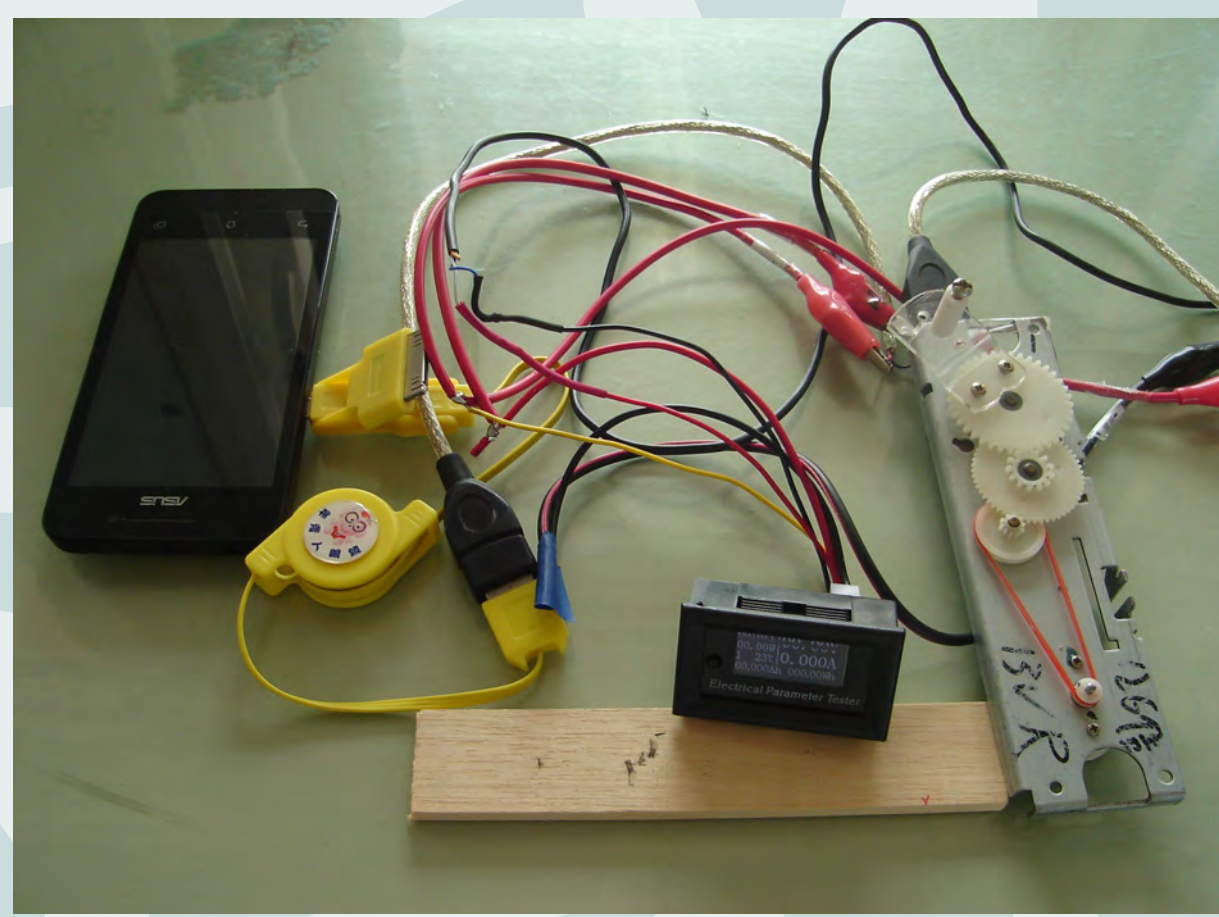
圖8 測試發電機對手機的充電量
