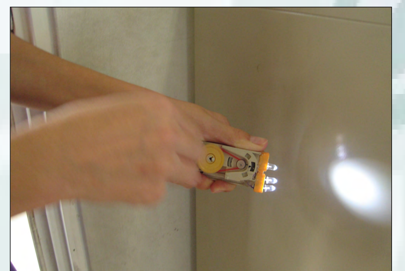
圖 3 手搖發電機使白 LED 燈亮起情形
