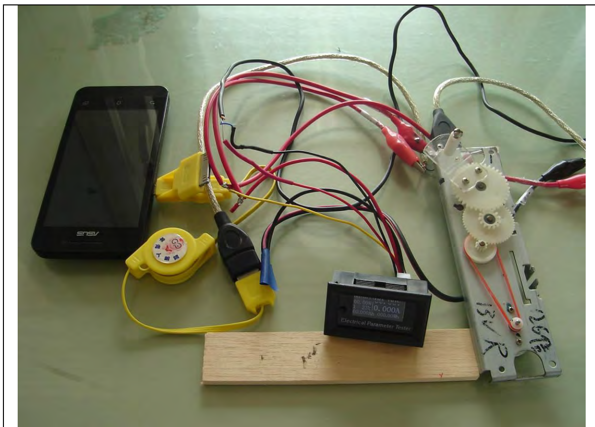
圖 8 測試我們的發電機對手機的充電量
