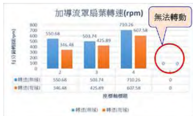
圖 8、扇葉外圍加上導流罩作固定風量下之轉速測量
