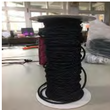
圖二、自製安全護網使用的尼龍繩。
