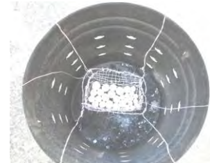
自製鐵絲網籃置放陶珠 鐵絲網籃可懸掛在金爐內 懸掛高度約為 1/2 燒金 1 大疊為 5 小疊
