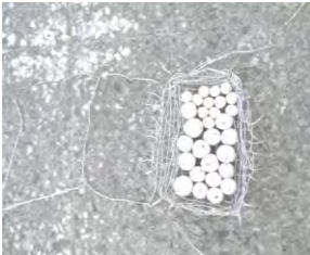
自製鐵絲網籃置放陶珠 鐵絲網籃可懸掛在金爐內 懸掛高度約為 1/2 燒金 1 大疊為 5 小疊
