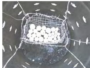
自製鐵絲網籃置放陶珠 鐵絲網籃可懸掛在金爐內 懸掛高度約為 1/2 燒金 1 大疊為 5 小疊
