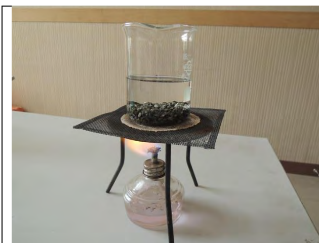
(圖十七) 加熱再生法
