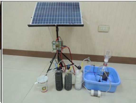
(圖三十八) 太陽能全自動淨水系統完成圖
