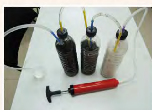
(圖十四) 氣動式過濾器裝有濾材
