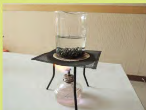
(圖十七) 加熱再生法
