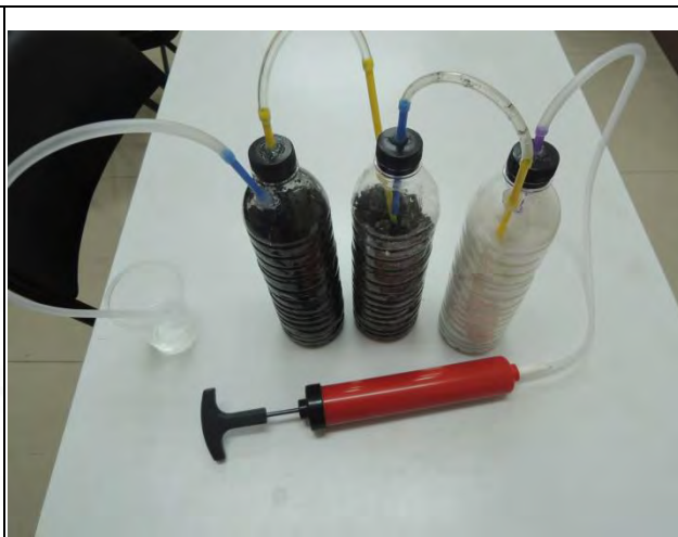
(圖十四) 氣動式過濾器 裝有濾材
