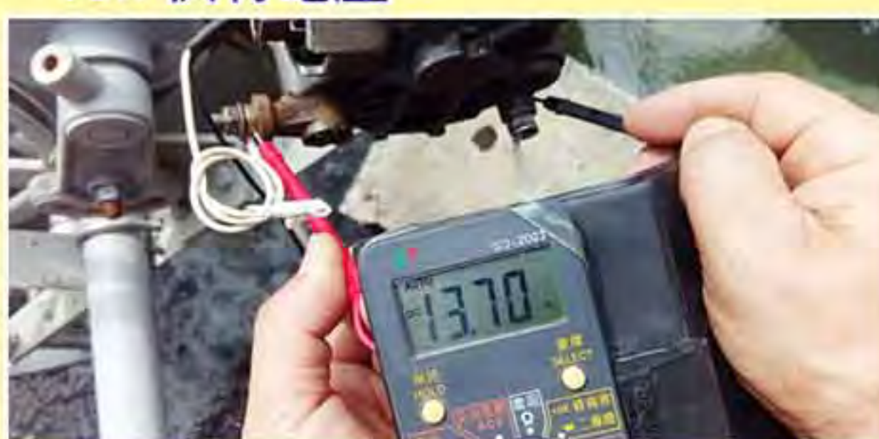
全罩式鐵板擋水後發電機可產生13.7伏特電壓
