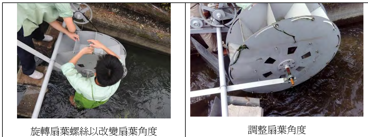
圖 9 調整扇葉角度的測試情形
