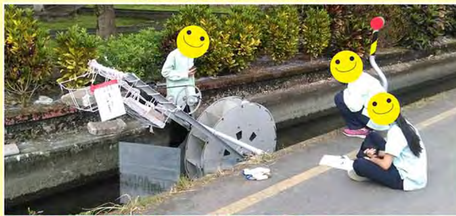
圖7 測量水圳的大小、流速、流量
