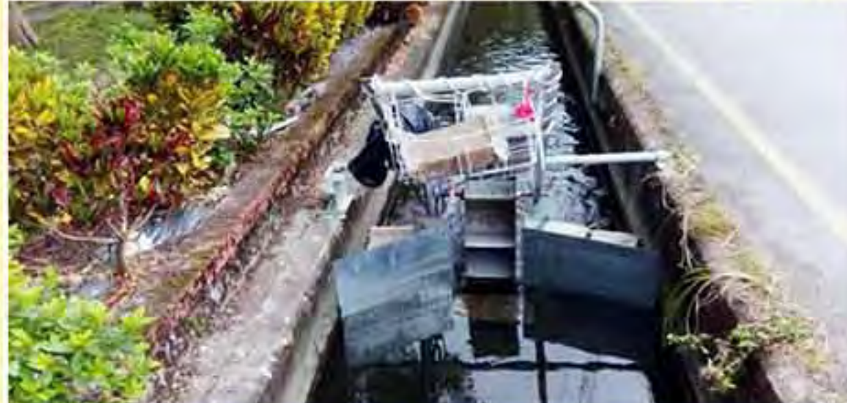
全罩式鐵板擋水後發電機可產生13.7伏特電壓
