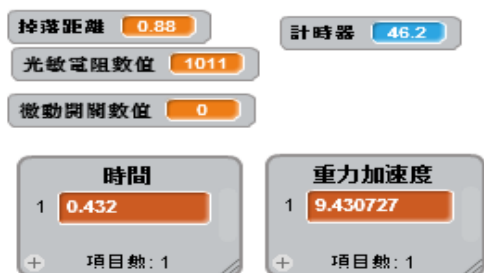
圖 (10) Scratch 顯示紀錄時間並計算出重力加速度
