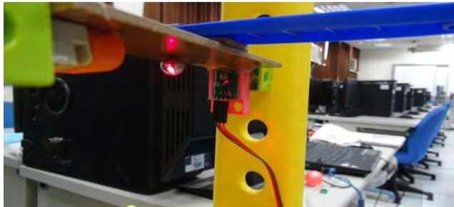
圖 (1) 以強力磁鐵吸住小鋼珠使之阻斷雷射光
