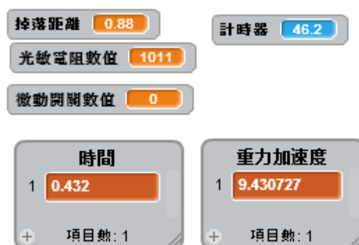
圖(10) Scratch 顯示紀錄時間並計算出重力加速度
