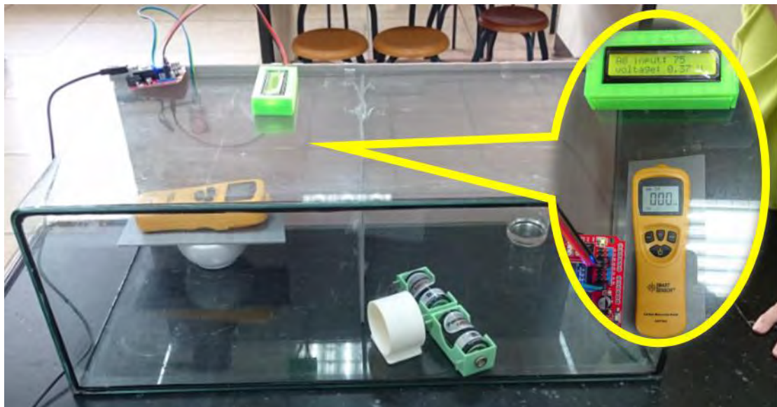
(圖 8) MQ-9 氣體感測器校正實驗裝置
