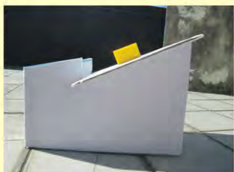
晷面加上仰角24.68度的傾斜底座
