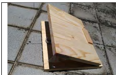
底座上有指北針可以定方位，有量角器可量測斜面傾斜角。
