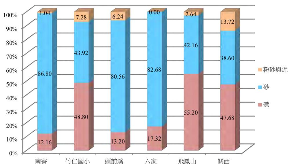
圖 23、各採樣點的土壤粒徑重量百分比示意圖 (各取用 500 克的土壤過篩)
