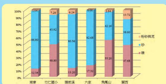
圖23 各採樣點的土壤粒徑重量百分比示意圖(各取用500克的土壤過篩)
