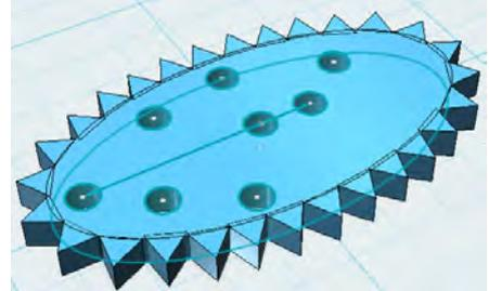
畫圓之後再轉 Cura，如右圖，調整好他的速度後最後在下指令讓 3D 列印機列印，在列印時我失敗很多次，做了很多調整，包括噴頭到平台的距離等等，最後終於做出了我要的模型。
